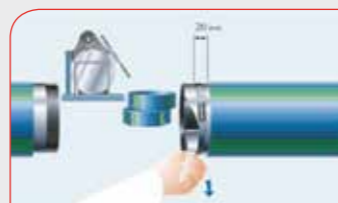
Afb. 18: De aluminium barrièrelaag verwijderen
