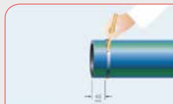
Afb. 16: Het te verwijderen gedeelte van de mantel markeren
