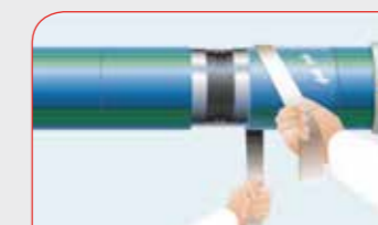
Afb. 24: Krimpgebied voor de mof radiaal met schuurlijnen opruwen
