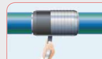
Afb. 11: De elektrolasfitting met aluminium tape omwikkelen
