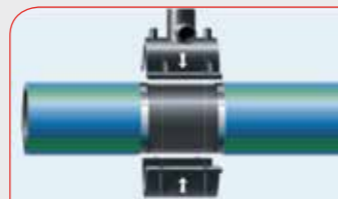
Afb. 35: Het aanboorstuk plaatsen
