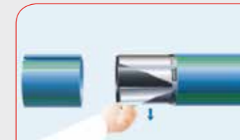
Afb. 7: De aluminium barrièrelaag met behulp van een slangklem verwijderen
