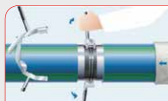
Afb. 22: De lasril met een uitwendige rilverwijderaaf verwijderen
