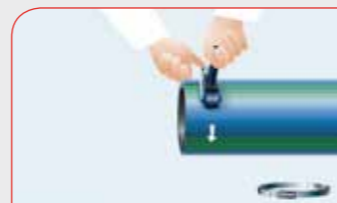
Afb. 17: De beschermmantel met een geschikt schilapparaat verwijderen
