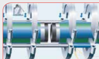
Afb. 20: De speciale inspanklemmen aanbrengen
