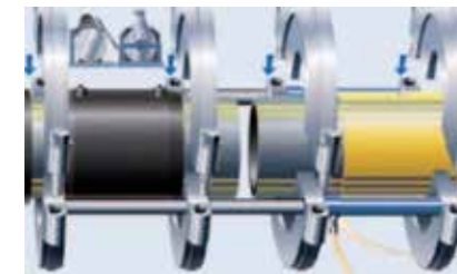
Afb. 6.5 Inspannen van de buisuiteinden in de stuiklasmachine
