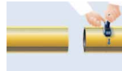
Afb. 6.14 De beschermmantel verwijderen (alleen bij HexelOne SLM) met het egeplast-schilapparaat M10
