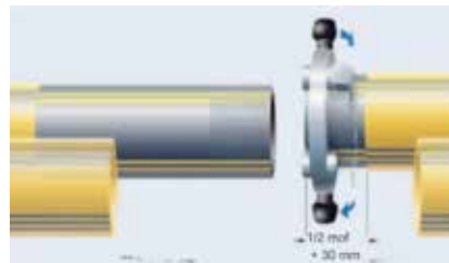
Afb. 6.3 De oxidelaag met een rotatieschiller verwijderen
