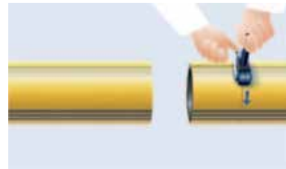
Afb. 6.32 De beschermmantel verwijderen (alleen bij HexelOne SLM) met het egeplast-schilapparaat M10
