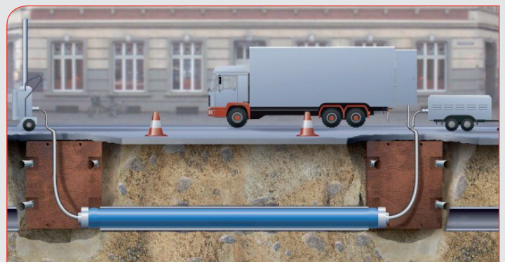
Diameter van de egeliner® herstellen door middel van stoom
